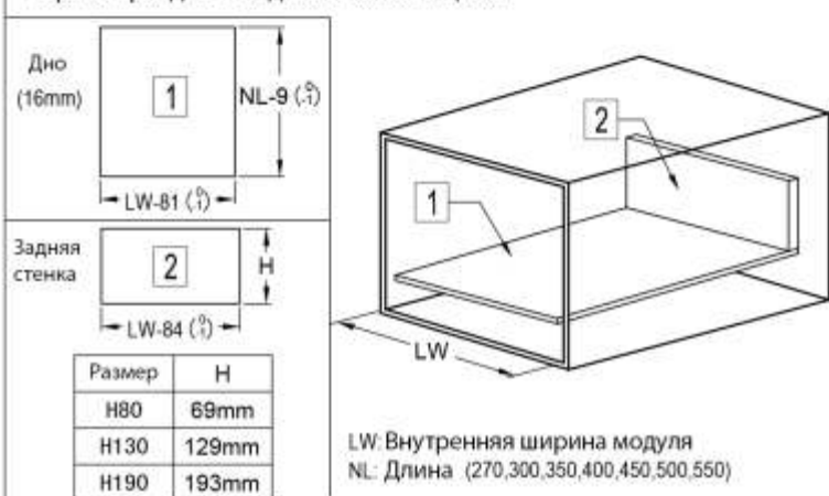
Установка ящика (H130/H190)
